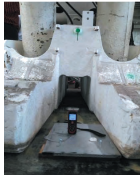
Rys. 5. Ręczny pomiar wysokości pracy obudowy zmechanizowanej
