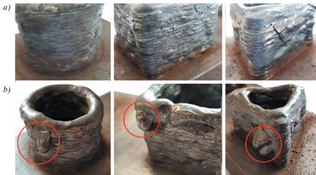
Rys. 9. Poprawnie wykonane modele napawane przestrzennie (a) oraz widoczne braki wynikające ze zbyt wysokiej temperatury międzyścięgowej (b). Fragmenty z brakami nie były brane pod uwagę przy weryfikacji metrologicznej
