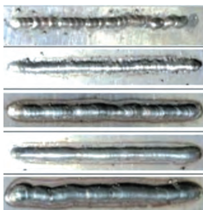
Rys. 4. Próby napawania przy natężeniu 100 A. Najlepsze lico uzyskano przy prędkości podawania elektrody wynoszącej 11,5 m/min
