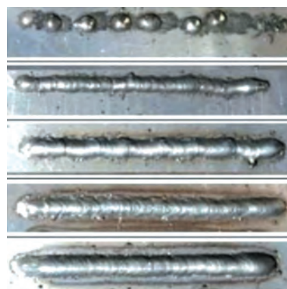
Rys. 5. Napawanie przy natężeniu prądu 150 A
