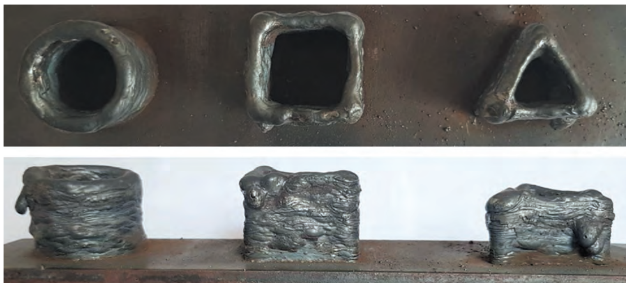
Rys. 8. Pierwsze próby napawania przestrzennego metodą MIG/MAG przy wykorzystaniu napawarki
