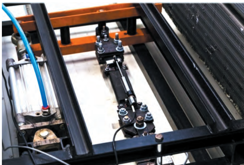
Rys. 4. Stanowisko do badań modułu sprężystości taśm w komorze klimatycznej
