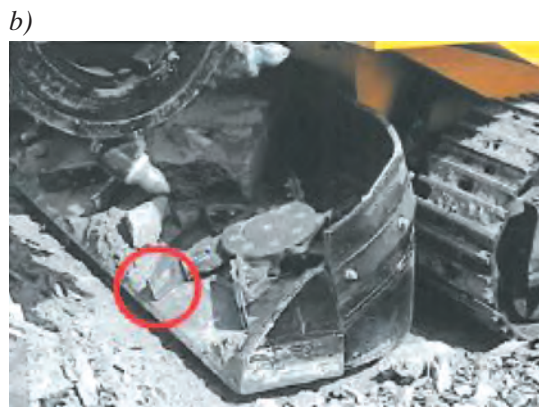
Rys. 4. Gwiazdy załadowcze: a) stan przed modernizacją, b) stan po modernizacji
