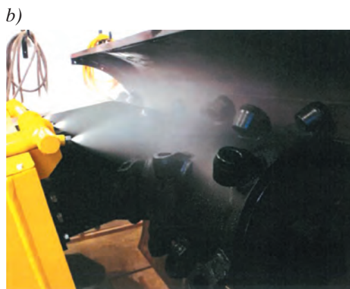
Rys. 5. Stanowisko badawcze układu zraszania: a) próby badawcze; b) działanie układu zraszania
