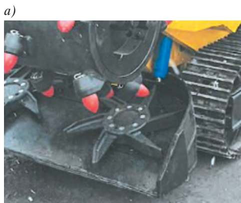
Rys. 4. Gwiazdy załadowcze: a) stan przed modernizacją, b) stan po modernizacji
