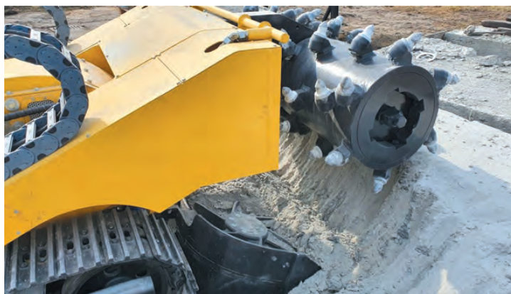
Rys. 3. Praca frezarki spągowej – urabianie bloków z kawałkami skał spągowych na poligonie badawczym
